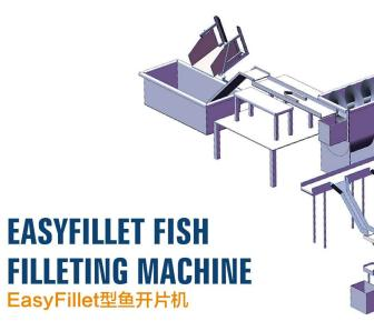
EasyFillet型鱼开片机是可实现对鱼大量且快速进行双面剖切处理的鱼 开片剖切装置。不仅提高了工作效率,而且剖切后所形成的鱼体因为是 流水生产线,减少了污染途径,为进一步的加工提供了方便。
